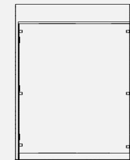
**PT Informação Técnica.** Cabines divisorias em painéis de compacto fenólico com espessura 13mm, com características de acordo com a norma EN438-2. Ferragem em aço inox AISI 316/304, incluindo: esquadros de fixação ao pavimento. Fixação lateral (paredes e painéis) com esquadros e suporte superior em perfil de alumínio.
