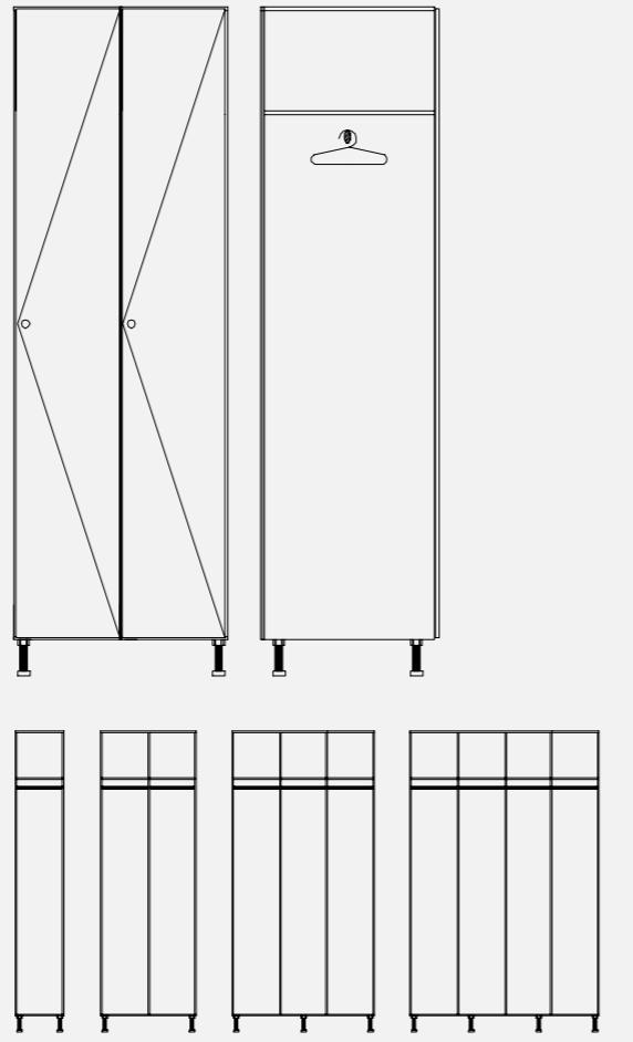
**PT Informação Técnica.** Cacifos com portas em painéis de compacto fenólico com espessura 13mm, estrutura em 10mm e traseira em 4mm com aberturas de ventilação. Ferragem com fixações em aço inox, pés reguláveis, dobradiças ocultas e opções de fechadura incluindo soluções eletrónicas.
