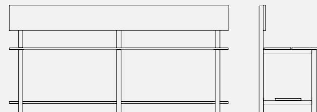
**PT** **Informação Técnica.** Banco simples ou duplo em compacto fenólico 13mm, estrutura tubular em aço inox AISI 304 e niveladores.
