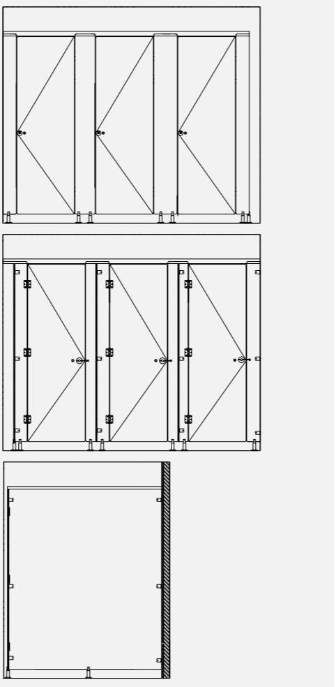
**PT Informação Técnica.** Cabines divisorias em painéis de compacto fenólico com espessura 13mm, com características de acordo com a norma EN438-2. Ferragem em aço inox AISI 316/304, incluindo: pés reguláveis em altura, dobradiças, fecho livre/ocupado e puxador duplo. Fixação lateral (paredes e painéis) com esquadros e suporte superior em perfil de alumínio.
