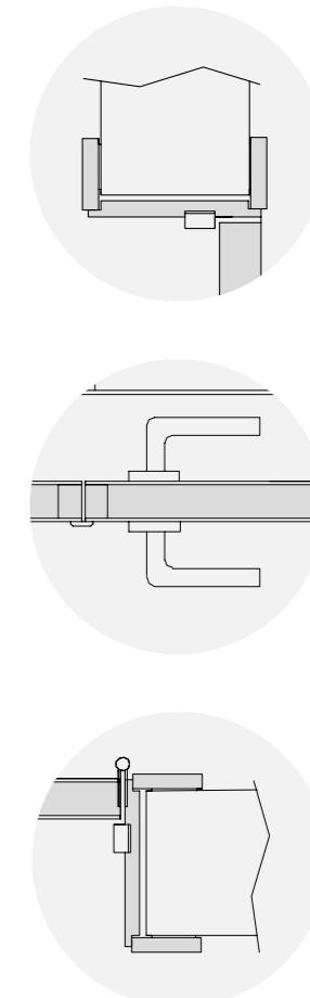
**PT Informação Técnica.** Portas em painéis de compacto fenólico sandwich (EPS revestido a fenólico 3 ou 4mm) com espessura 38mm. Aro em fenólico 13mm e ferragem em aço inox, incluindo: dobradiças, fechadura ou fecho livre/ocupado e puxador.
