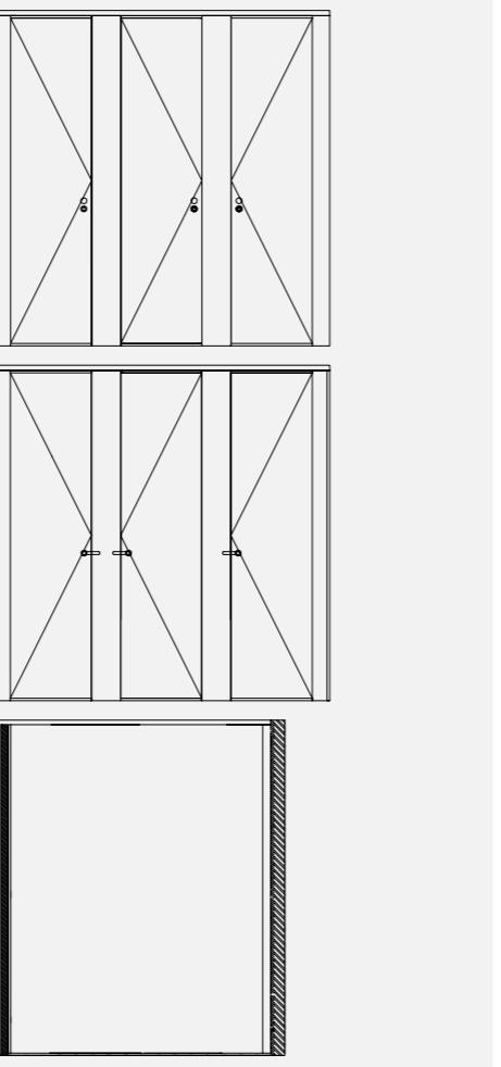
**PT Informação Técnica.** Cabines divisorias em painéis de compacto fenólico sandwich (EPS revestido a compacto fenólico) com espessura 46mm, com fixações ocultas. Ferragem em aço inox, incluindo: dobradiças invisíveis, fecho livre/ocupado e puxador duplo.
