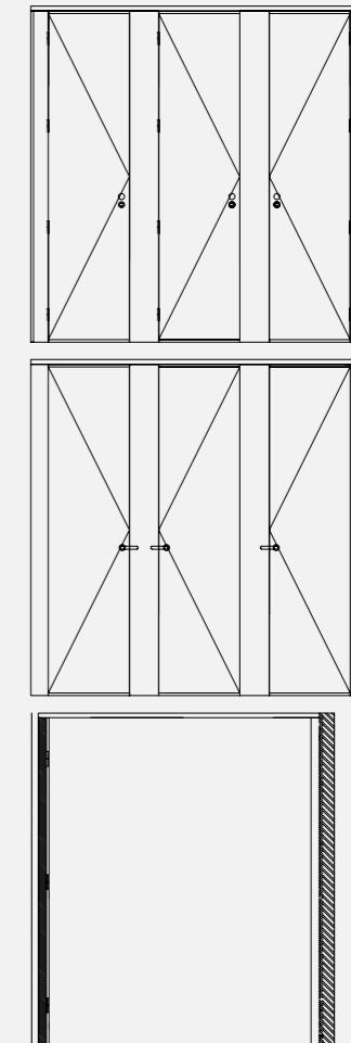
**PT Informação Técnica.** Cabines divisorias em painéis de compacto fenólico sandwich (EPS revestido a compacto fenólico) com espessura 46mm. Ferragem em aço inox, incluindo: dobradiças de eixo, fecho livre/ocupado e puxador duplo.
