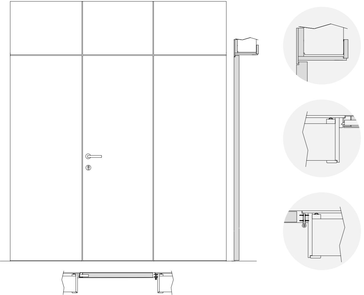
**PT Informação Técnica.** Portas em painéis de compacto fenólico sandwich (EPS revestido a fenólico 3 ou 4mm) com espessura 46mm. Aro em fenólico 13mm e revestimento em 6 ou 8mm, e ferragem em aço inox, incluindo: dobradiças, fechadura ou fecho livre/ocupado e puxador.
