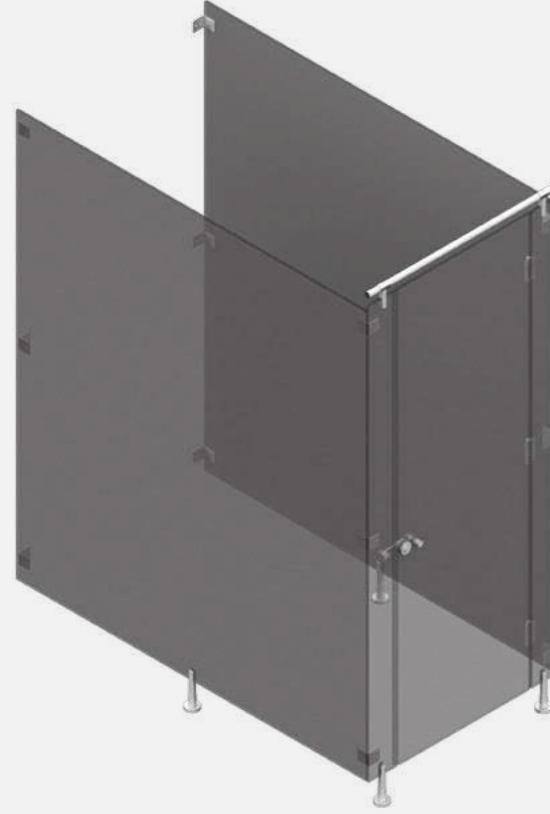
**PT Informação Técnica.** Cabines divisorias em painéis de compacto fenólico com espessura 13mm, com características de acordo com a norma EN438-2. Ferragens em aço inox AISI 316/304, incluindo: pés reguláveis em altura, dobradiças, fecho livre/ocupado e puxador duplo. Fixação lateral (paredes e painéis) com esquadros e suporte superior em tubo inox com fixação às paredes e suporte de painel.
