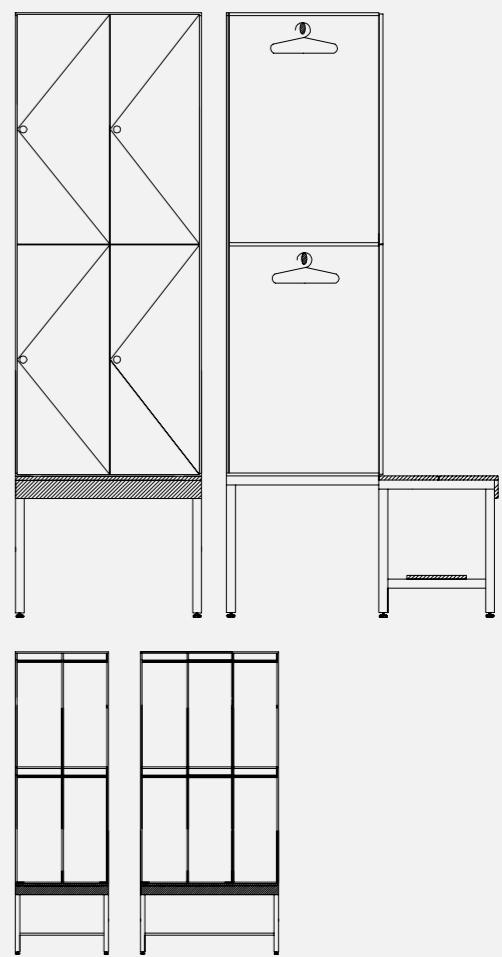
**PT Informação Técnica.** Cacifos com portas em painéis de compacto fenólico com espessura 13mm, estrutura em 10mm e traseira em 4mm com aberturas de ventilação. Banco simples ou com sapateira em compacto fenólico 13mm, estrutura tubular em aço inox e niveladores.
