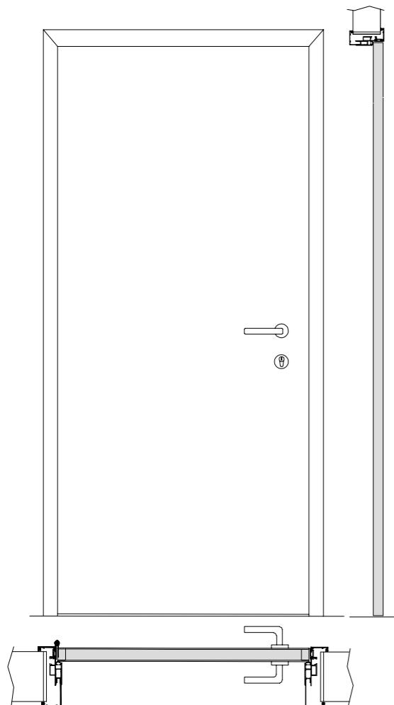
**PT Informação Técnica.** Portas em painéis de compacto fenólico sandwich (EPS revestido a fenólico 3 ou 4mm) com espessura 38mm. Aro telescópico em alumínio e ferragem em aço inox, incluindo: dobradiças, fechadura ou fecho livre/ocupado e puxador.
